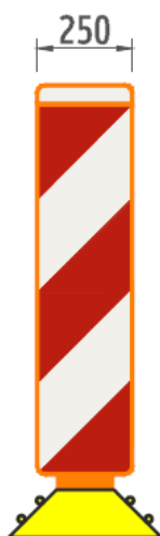
Obrázok 13 – Vodiaci prah (údaje uvedené v mm)
